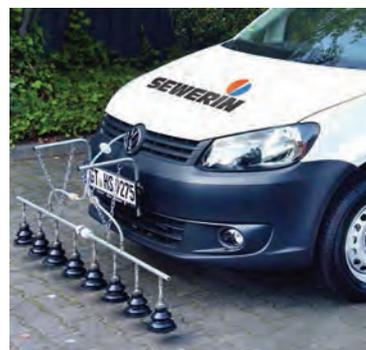
gestiona desde el *software* SeCuRi SAT. El LaserGasPatroller aspira el gas que sale de la tubería de gas por el punto de fuga y se propaga a través del terreno hasta la superficie de la calzada o de la carretera y, a continuación, lo conduce hasta el sistema de medición LGP 800 para analizarlo. Las fugas existentes son detectadas por medio de la cámara de dispersión y registradas automáticamente por el *software* SeCuRi SAT.
