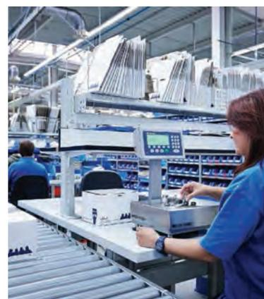
todos los procesos de pesaje en los que la calidad resulta esencial y las tolerancias se deben minimizar. Estas indican al operador cuándo es necesaria la recalibración o los ajustes debido a los cambios en el entorno. La calibración automatizada con peso de calibración incorporado y los cables enchufables facilitan el mantenimiento. Por tanto, son apropiadas para
