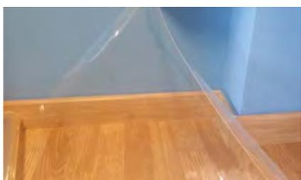
Figura 10. Transparencia del poliuretano termoplástico.
