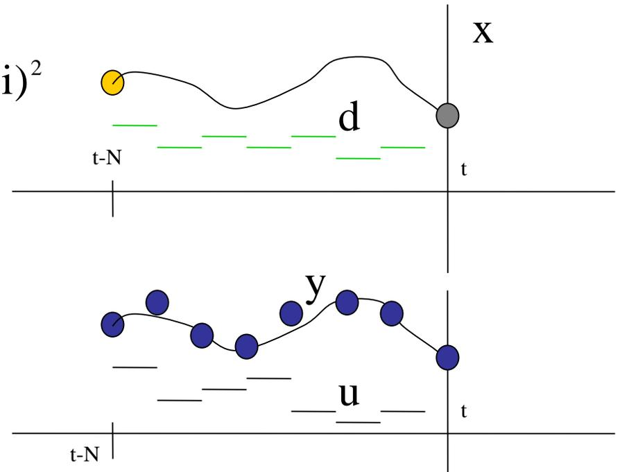
Una vez que se han calculado los  $x(t-N)$  y  $d(t-N), d(t-N+1), \dots$  óptimos,  $x(t)$  se puede estimar por simulación del modelo comenzando en  $x(t-N)$  y aplicando los controles  $u(t-N), u(t-N+1), \dots$  y perturbaciones  $d(t-N), d(t-N+1), \dots$  hasta el tiempo  $t$
