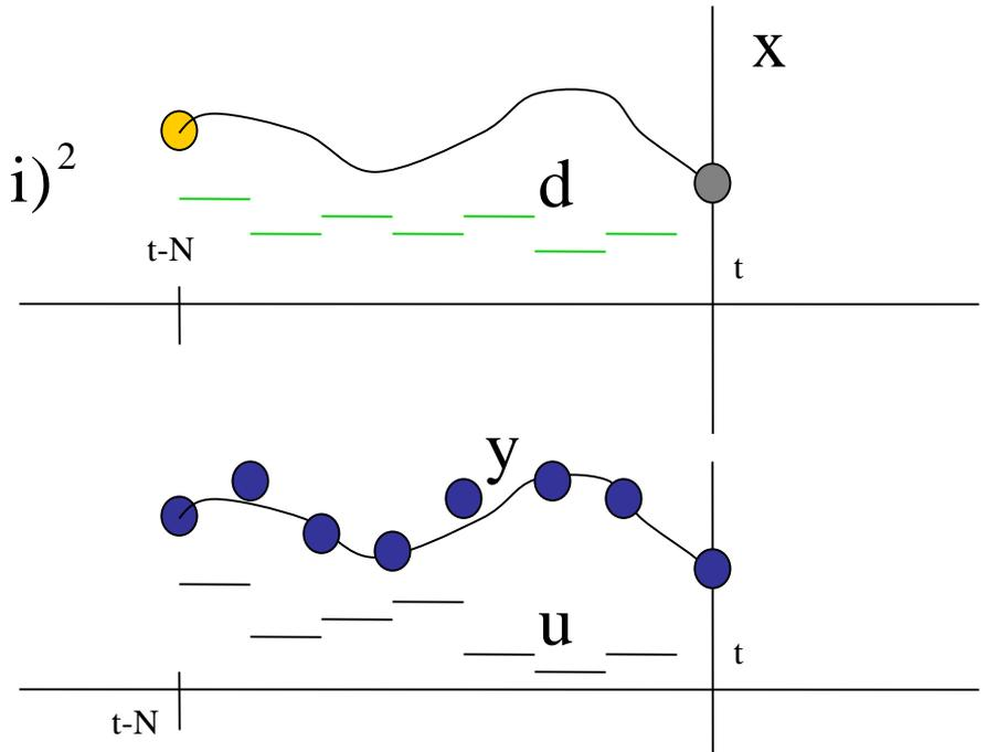
Qué estado inicial en  $t-N$  and  $y$  perturbaciones mínimas  $d(t-i)$  llevarían al proceso a evolucionar de la forma más cercana a los valores medidos  $y(t-i)$  en el intervalo  $[t-N, t]$  si se aplicaran las acciones de control  $u(t-i)$  realmente aplicadas en dicho intervalo?
