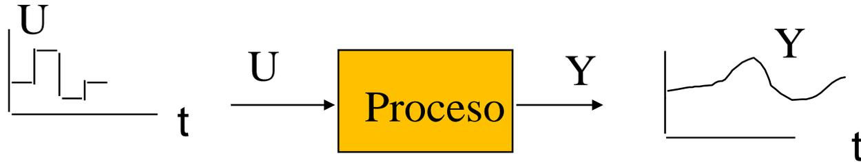
$$y(t) = \sum_{i=1}^m h_i u(t-i) + v(t) \quad y(t)u(t-j) = \sum_{i=1}^m h_i u(t-i)u(t-j) + v(t)u(t-j)$$
