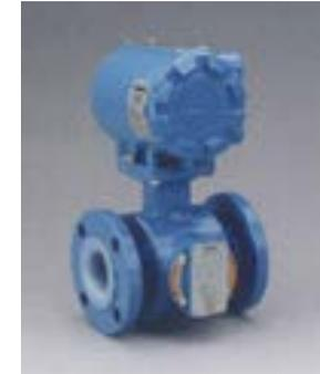
En el conductor (líquido) que circula a una velocidad en el seno del campo  $B$  se induce una f.e.m. proporcional a la velocidad, que se recoge en los electrodos
