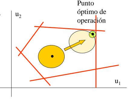
**RTO**: Modelos del proceso y especificaciones + software de optimización + implementación
