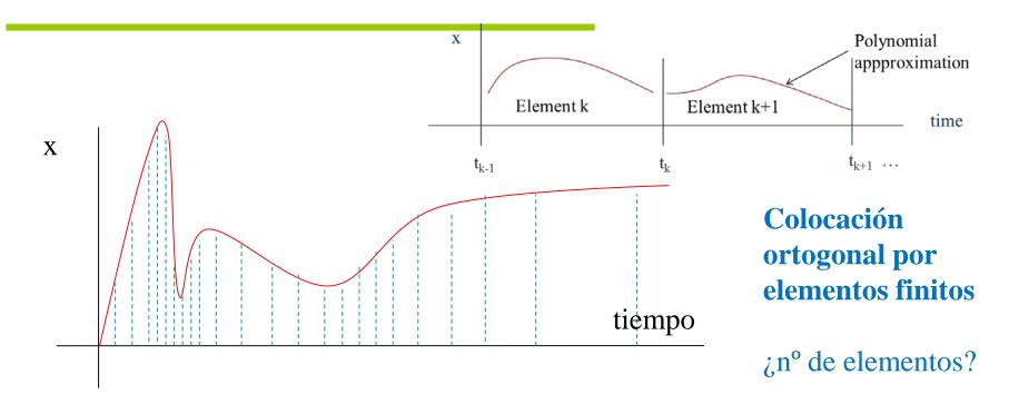
La integración de sistemas stiff usa métodos de paso y estructura variable para mantener el error de integración bajo cotas.
