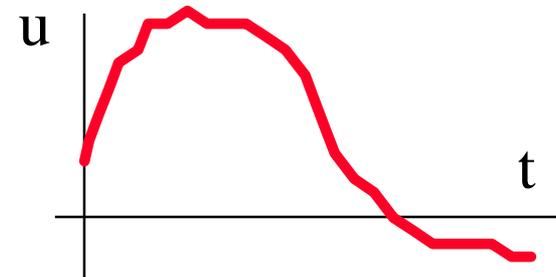
Un error del  $x\%$  provoca una acción de control del  $K_p x\%$  sobre el actuador
