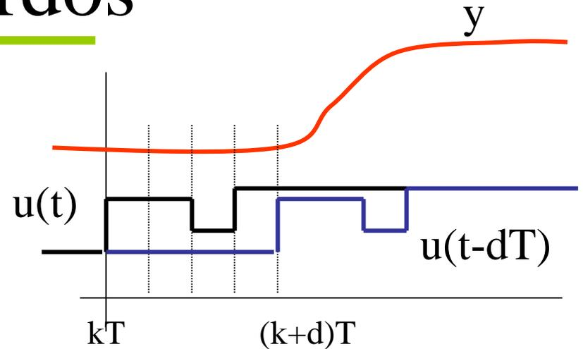
$$x((k+1)T) = e^{AT}x(kT) + \int_{kT}^{(k+1)T} e^{A((k+1)T-\sigma)} Bu(\sigma - dT) d\sigma$$
